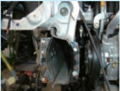
軟鋼用スポットにて作業している為、溶着が不完全
